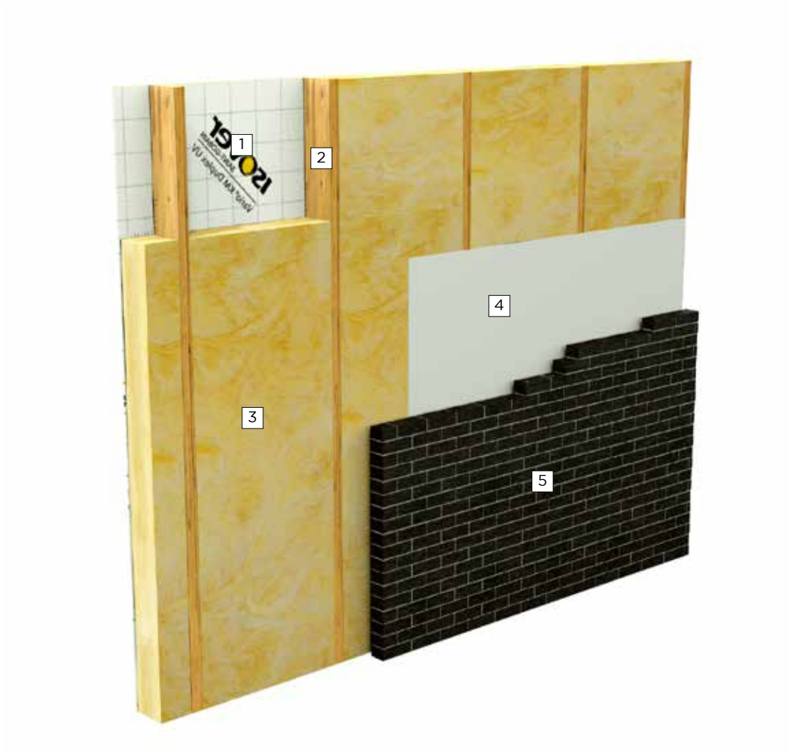
1-Vario® KM duplex 2-Ossature bois 3-Systemroll 4-Protection antipluie 5-Brique de parement
