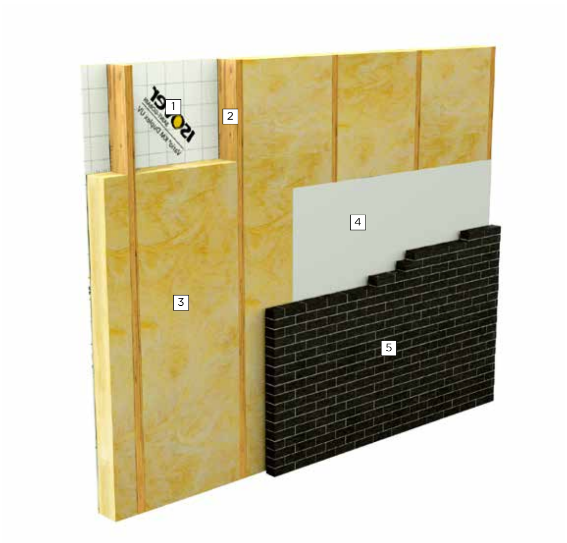
1-Vario® KM duplex 2-Houtskelet 3-Systemroll 4-Regenscherm 5-Gevelsteen
